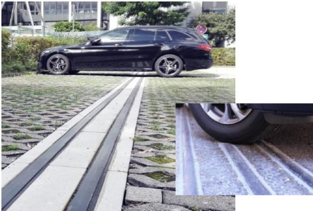
**Abb. 2:** Optischer Sensor für die P+R-Anlage ME-Stadtwald (Cleverciti Systems GmbH)
