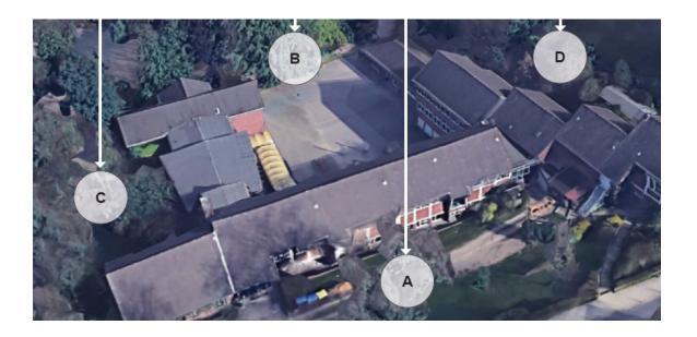
Standort A: Direkte Nähe zur Hans-Böckler-Straße, starke Hanglage, hoher Aufwand an Erdarbeiten zur Aufstellung der Fertigbaumodule.
