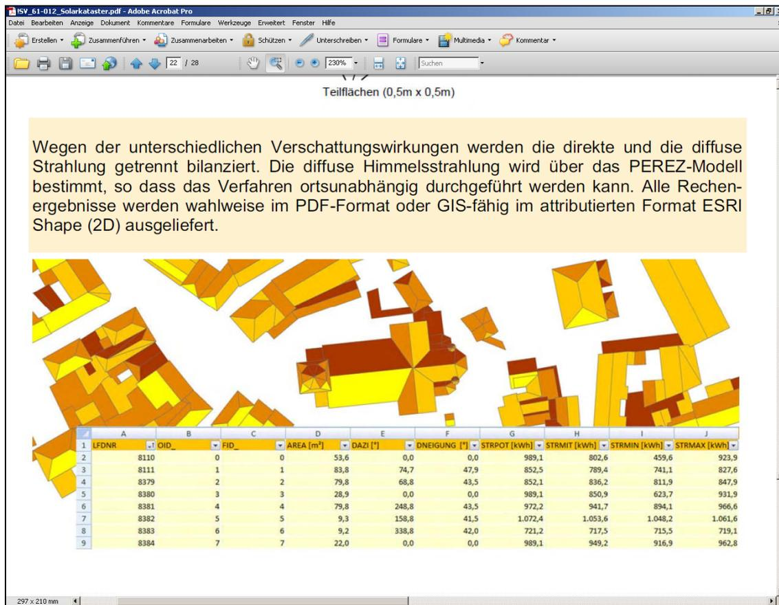
Abb. 9: Genaue Dachflächen- und 3D-Modellierung
