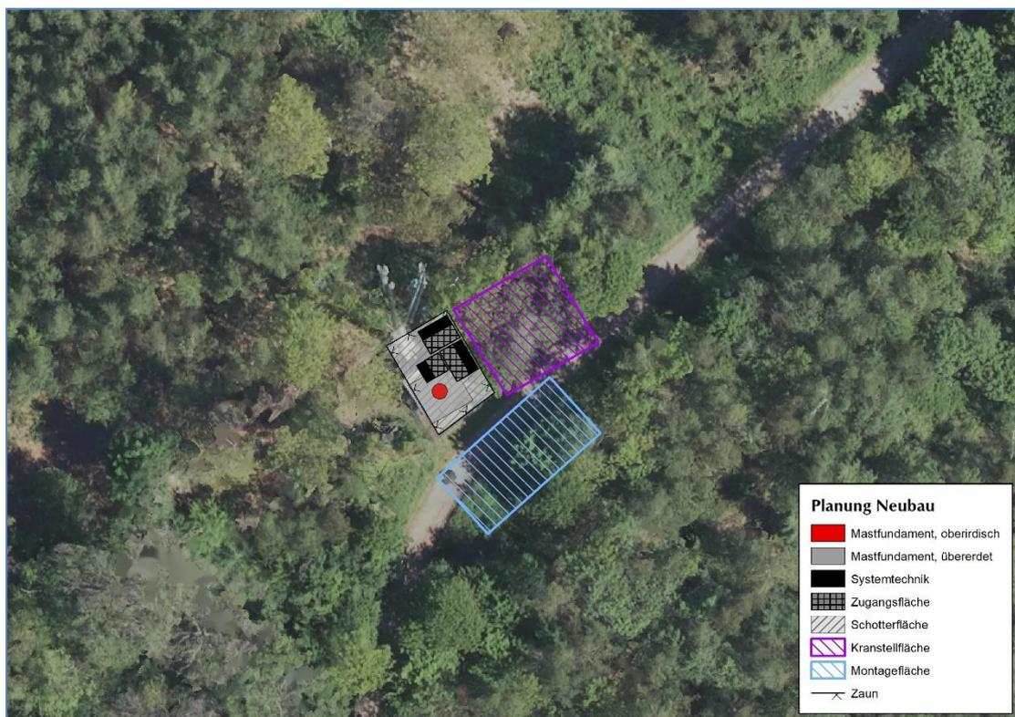
Abb. 3: Schematische Darstellung der Planung des Ersatzneubaus (Kartengrundlage DOP © Geobasis NRW, Köln 2022, dl-de/by-2-0, [https://www.wms.nrw.de/geobasis/wms\\_nw\\_dop](https://www.wms.nrw.de/geobasis/wms_nw_dop))
