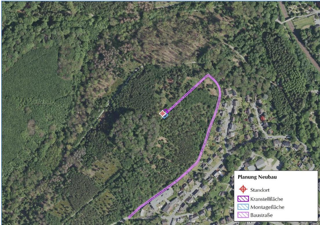
Abb. 4: Schematische Darstellung der geplanten Baustraße mit Verbreiterung des bestehenden Weges (Kartengrundlage DOP © Geobasis NRW, Köln 2022, dl-de/by-2-0, [https://www.wms.nrw.de/geobasis/wms\\_nw\\_dop](https://www.wms.nrw.de/geobasis/wms_nw_dop))
