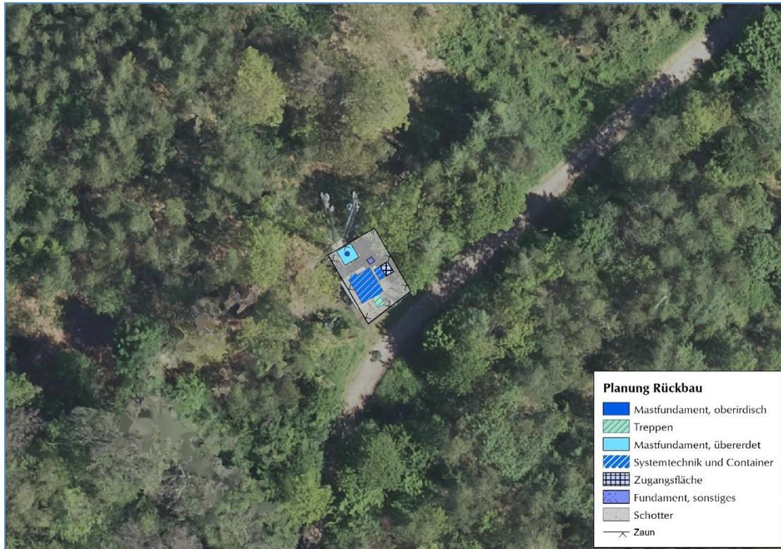
Abb. 2: Schematische Darstellung des Rückbaus des Bestandsmastes (Kartengrundlage DOP © Geobasis NRW, Köln 2022, dl-de/by-2-0, [https://www.wms.nrw.de/geobasis/wms\\_nw\\_dop](https://www.wms.nrw.de/geobasis/wms_nw_dop))
